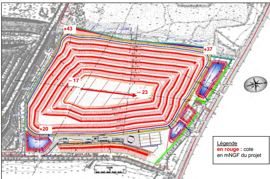
La structure du fond de casier présentera une pente globale orientée vers le Nord/Nord-Est, pour converger vers l'angle Nord-Est, où sera placé le puits de relevage des lixiviats. Le fil d'eau principal sera situé côté Est du casier et aura une pente d'au moins 2% vers le Nord. Le réseau secondaire aura une pente d'environ 1,5% dirigé vers le fil d'eau principal. Cela conduit globalement à un fond de casier situé entre les cotes -17 mNGF au Sud et -23 mNGF dans l'angle Nord-Est.
